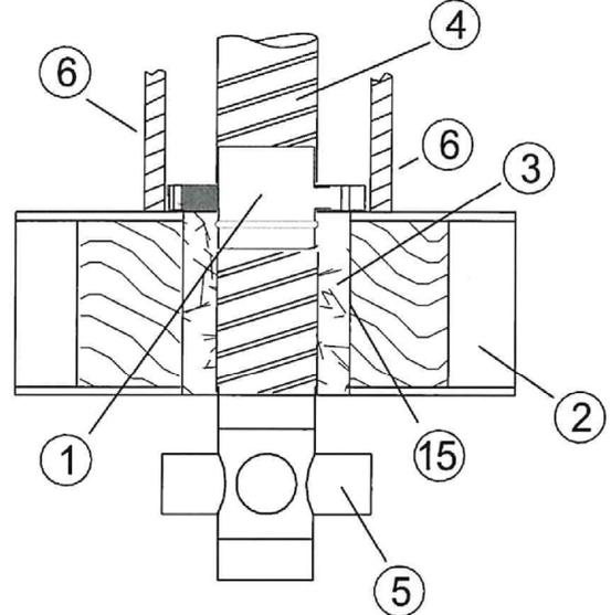
Einbau in der Geschossdecke aus Holz, Holzbalkendecke F 30-B - F 90-B
