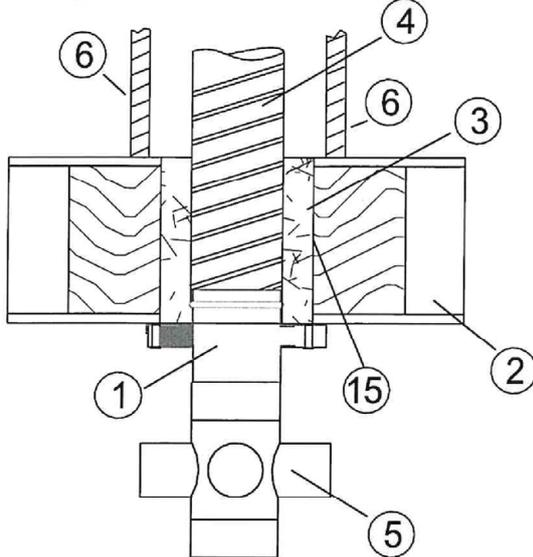
Einbau auf der Geschossdecke aus Holz, Holzbalkendecke F 30-B - F 90-B
