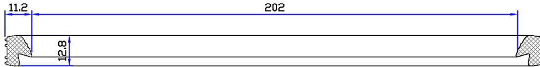
Dichtung Kugelgelenk DN/OD 200
