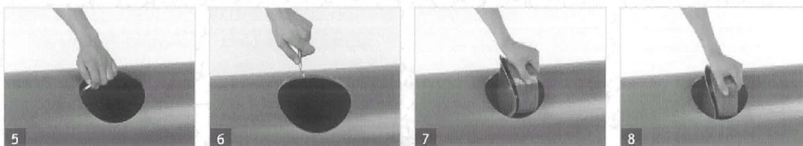
Nach korrektem Erstellen der Bohrung Kanten mit geeignetem Werkzeug innen (5) und außen (6) entgraten. Unterteil des CONNEX®-Anschlusses durch die Bohrung in das Hauptrohr drücken (7+8+9). **Kein Gleitmittel auf die untere Dichtung auftragen!**
