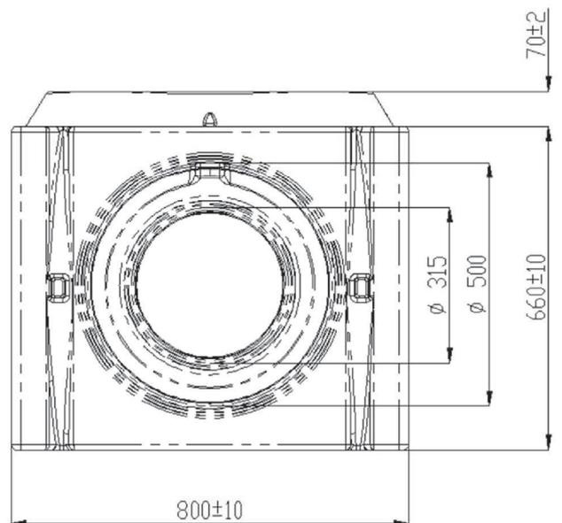
Versickerungsblöcke für die Versickerung von Niederschlagswasser mit der Bezeichnung „RAUSIKKO Box“
