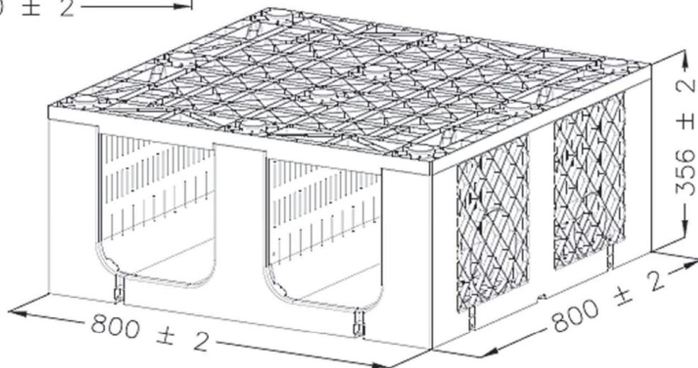
Versickerungsblöcke für die Versickerung von Niederschlagswasser mit der Bezeichnung „RAUSIKKO Box“
