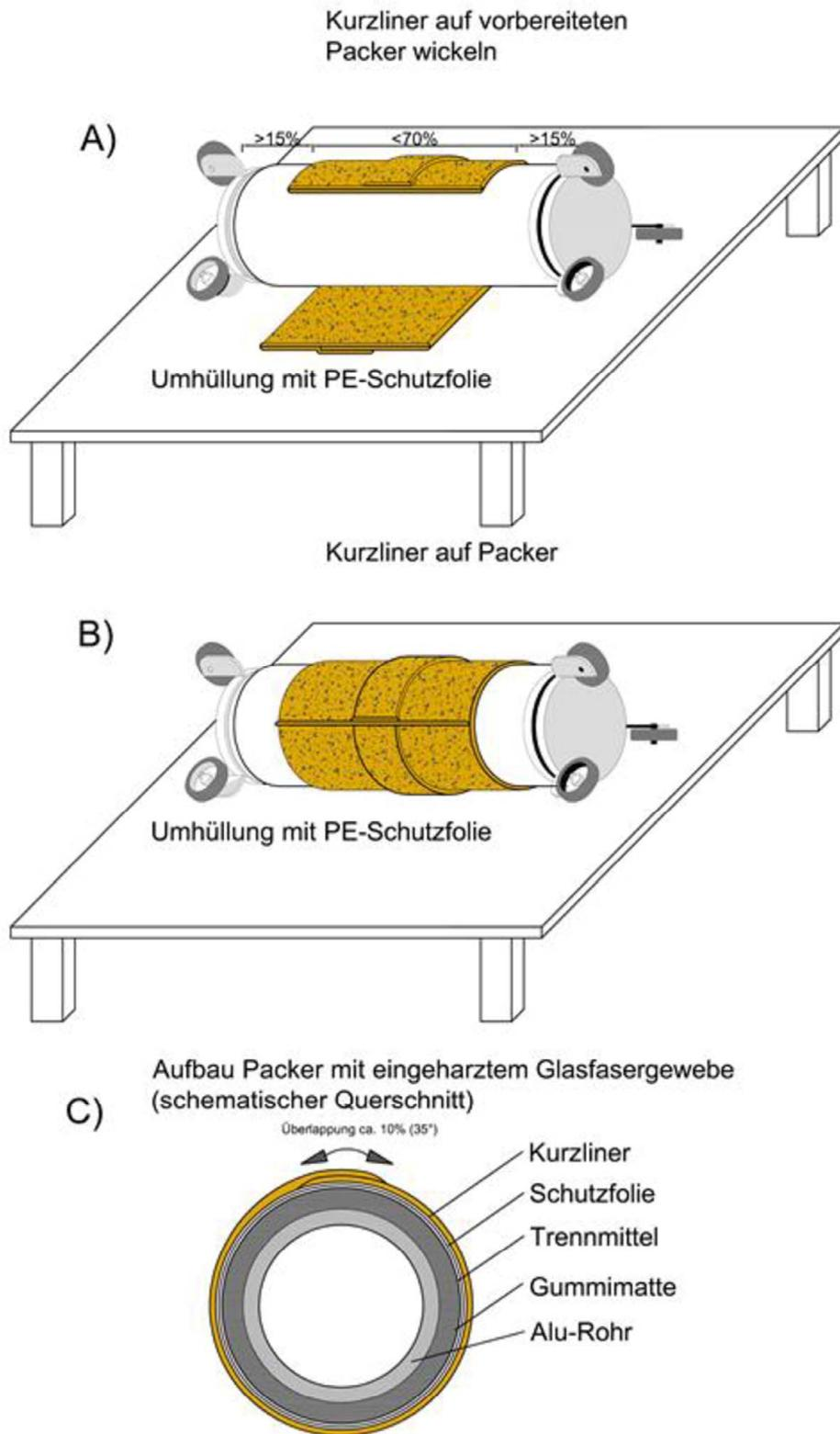
Kurzliner mit der Bezeichnung "CarboLith Spot Repair System" zur Sanierung erdverlegter schadhafter Abwasserleitungen im Nennweitenbereich von DN 100 bis DN 500
