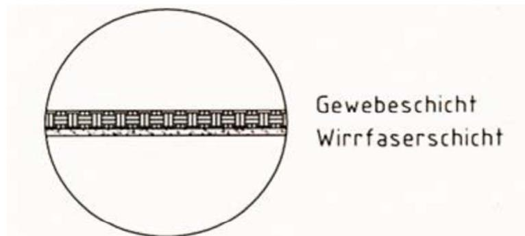
Kurzliner mit der Bezeichnung "CarboLith Spot Repair System" zur Sanierung erdverlegter schadhafter Abwasserleitungen im Nennweitenbereich von DN 100 bis DN 500
