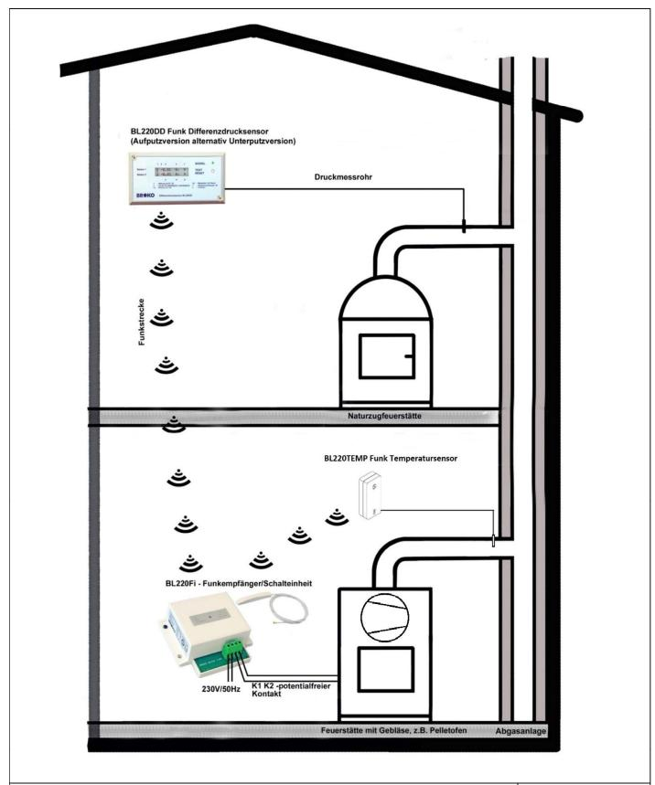
Einrichtung zur Überwachung einer mehrfachbelegten Abgasanlage für den Anschluss von Feuerstätten mit und ohne Gebläse
