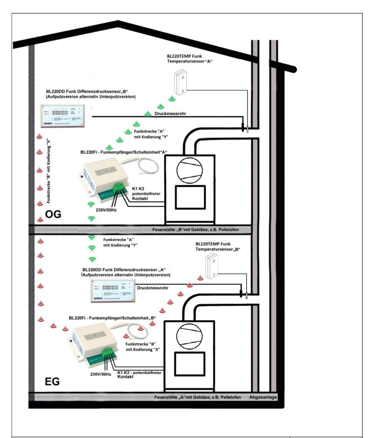
Einrichtung zur Überwachung einer mehrfachbelegten Abgasanlage für den Anschluss von Feuerstätten mit und ohne Gebläse
