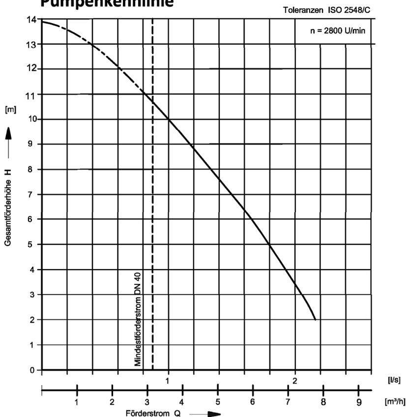
Abwasserhebeanlage Muli-UF MWP 1+2
