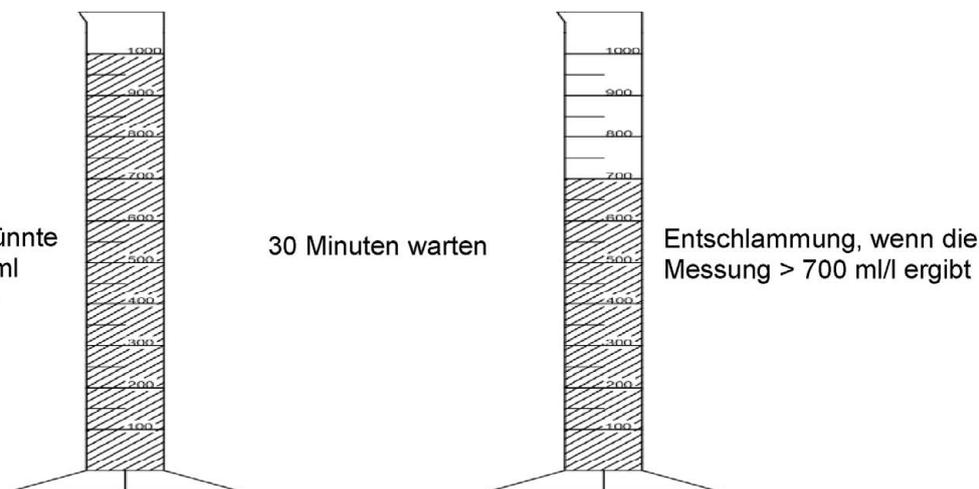
In den 2. Messzylinder wird parallel eine verdünnte Probe angesetzt. Die Verdünnung sollte nach unserer Empfehlung im Verhältnis 1+2 liegen (330 ml Schlamm und 670 ml Ablauf). Der abgelesene Wert ist dann mit dem Verdünnungsfaktor 3 zu multiplizieren).
