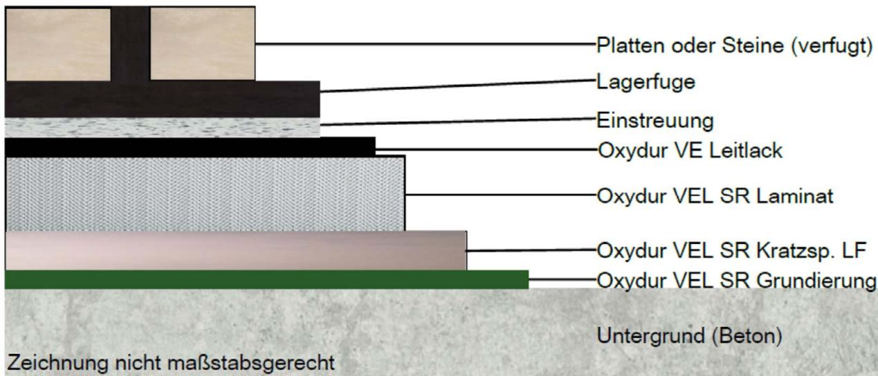
Abbildung1: Kombiniertes Auskleidungssystem mit Beschichtungssystem und Nuttschicht aus Platten oder Steinen gemäß Tabelle 1 verfugt mit Kunstharzkitt OXYDUR VEC oder FURADUR KITT
