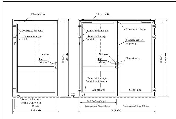
\* Bei Verwendung eines Falztreibriegels steht der LD-Gangflügel nur als Rettungsweg zur Verfügung. Dieses Maß verringert sich bei einem Öffnungswinkel von nur 90 Grad.
