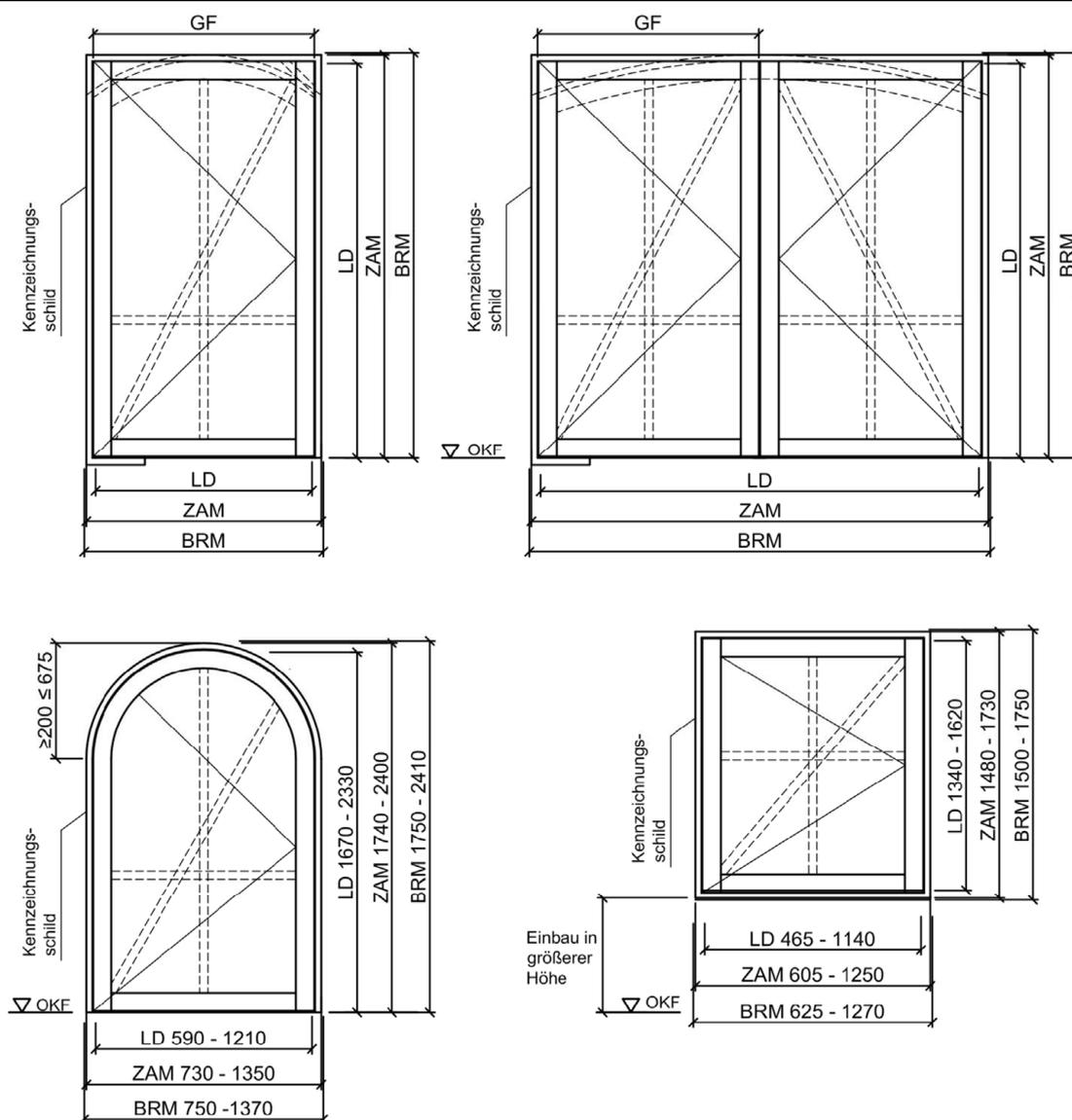
Die T 30-1-RS-Tür und T30-2-RS-Tür immer mit absenkbarer Bodendichtung oder 4-seitiger Zarge mit Dichtung ausführen und den Wandanschluss immer versiegeln!
