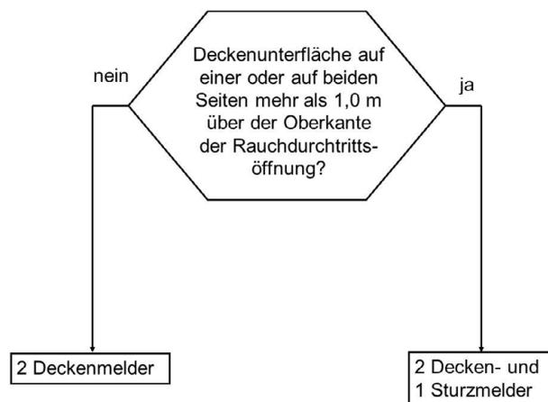
Bild 3: Entscheidungsdiagramm
