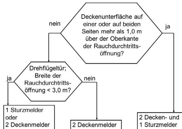
Bild 3: Entscheidungsdiagramm
