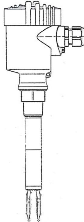
**Schema der Überfüllsicherung**
