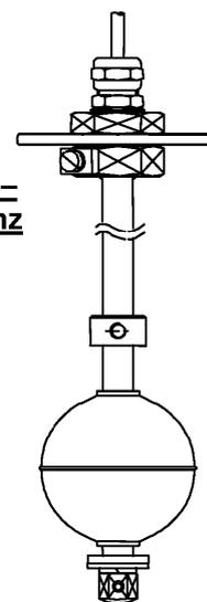
Standaufnehmer (Magnettauchsonde) Typ "T-20.F..." und Messumformer als Bauteile von
