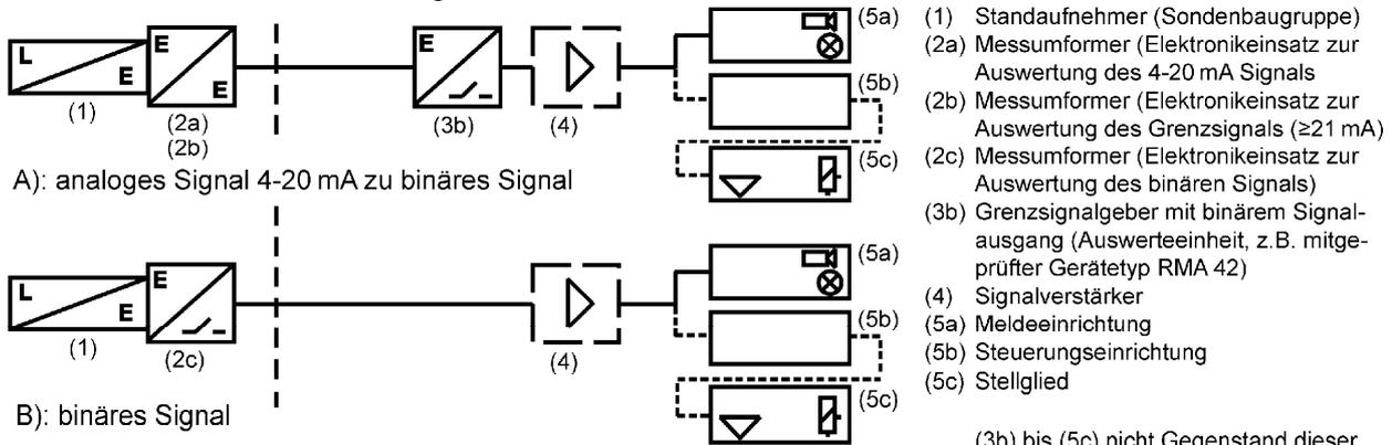
Standaufnehmer (Verdränger) "Proservo NMS8..." mit integriertem Messumformer als kontinuierliche Standmesseinrichtung von Überfüllsicherungen
