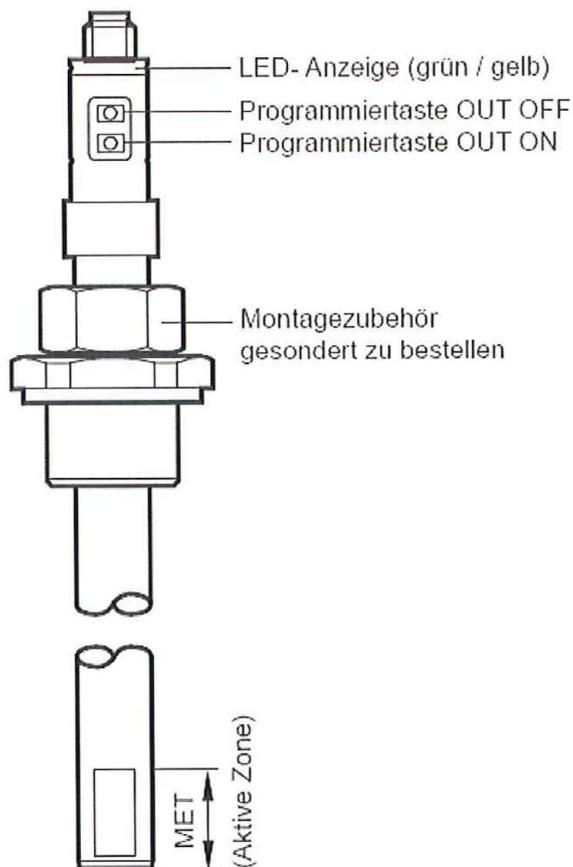
**Schema der Überfüllsicherung**
