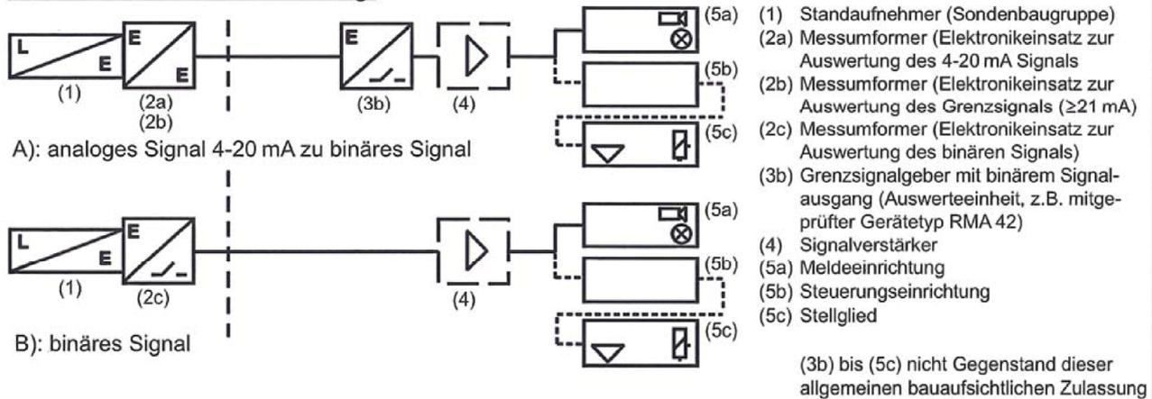
Standaufnehmer (Radar-Antenne) "Micropilot NMR8..." mit integriertem Messumformer als kontinuierliche Standmeseinrichtung von Überfüllsicherungen
