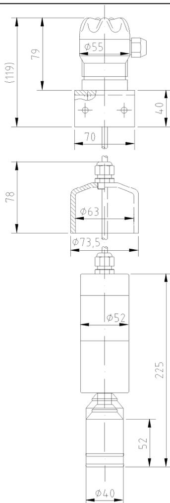
**Schema der Überfüllsicherung:**
