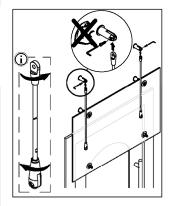
Die Zugstangen werden an den oberen Wandanschlussteilen befestigt.
