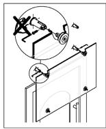
Auflageteller mit Glasschutz an der VSG Glasscheibe verschrauben. An der Wandseite wird das Gelenkstück auf der Unterseite verschraubt. An der Vorderseite der VSG Glasscheibe wird das Gelenkstück auf der Oberseite verschraubt.
