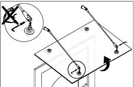
Scheibe anheben und die Zugstangen mit den Gelenkstücken auf der Oberseite der VSG Glasscheibe verschrauben.
