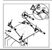
Die Neigung wird durch drehen der Zugstange eingestellt. Nach der korrekten Einstellung der Zugstange wir diese mit einer Sechskantmutter gesichert. Alle Zylinderschrauben müssen mit einem Drehmomentschlüssel (25NM) angezogen werden.
