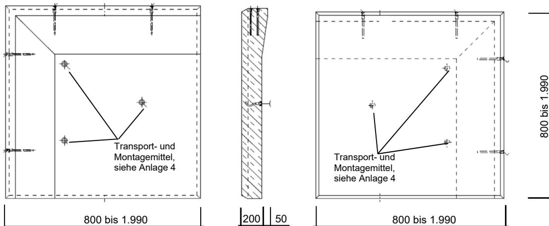
**Eckplatten-Element mit Entwässerung, Typ 2<sup>\*)</sup>:**
