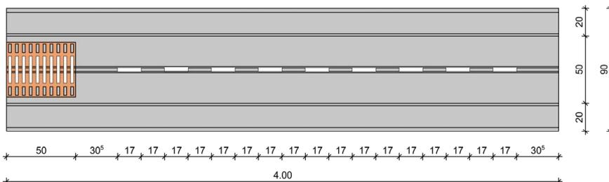
RIKI-CETON-SMART-Schlitzrinnensystem für die Verwendung in LAU-Anlagen
