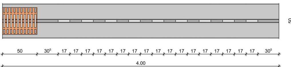
RIKI-CETON-SMART-Schlitzrinnensystem für die Verwendung in LAU-Anlagen
