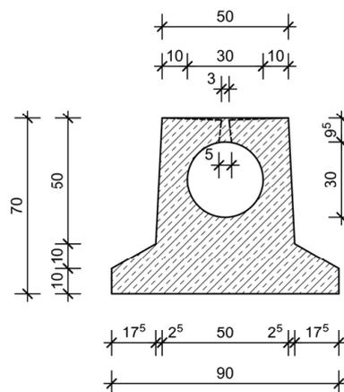
RIKI-CETON-SMART-Schlitzrinnensystem für die Verwendung in LAU-Anlagen
