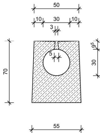
RIKI-CETON-SMART-Schlitzrinnensystem für die Verwendung in LAU-Anlagen
