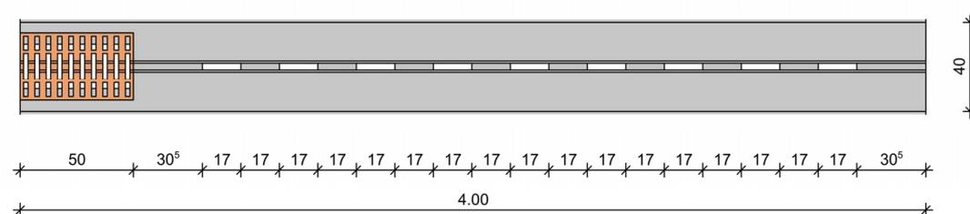
RIKI-CETON-SMART-Schlitzrinnensystem für die Verwendung in LAU-Anlagen
