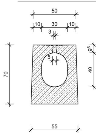
RIKI-CETON-SMART-Schlitzrinnensystem für die Verwendung in LAU-Anlagen
