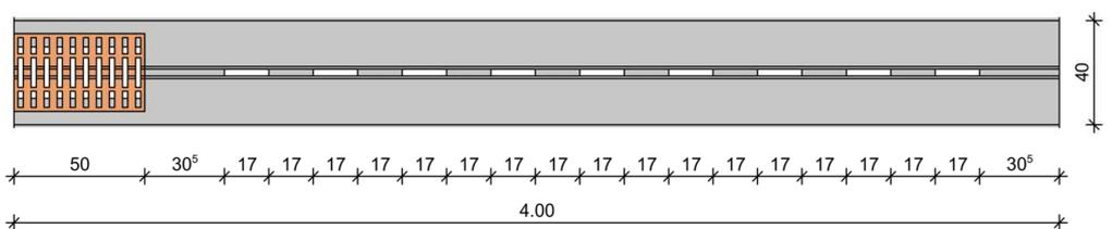
RIKI-CETON-SMART-Schlitzrinnensystem für die Verwendung in LAU-Anlagen
