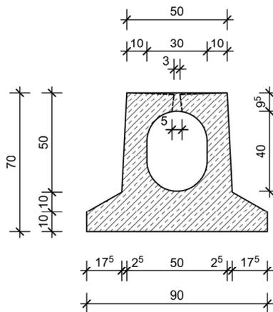
RIKI-CETON-SMART-Schlitzrinnensystem für die Verwendung in LAU-Anlagen
