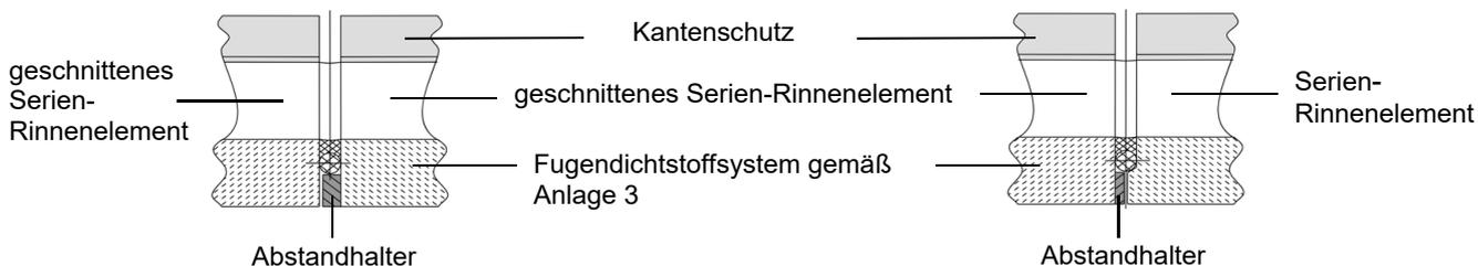
**Fugenanordnung im Detail Anschluss der Anfangs- bzw. Endscheiben (Längsschnitt)**
