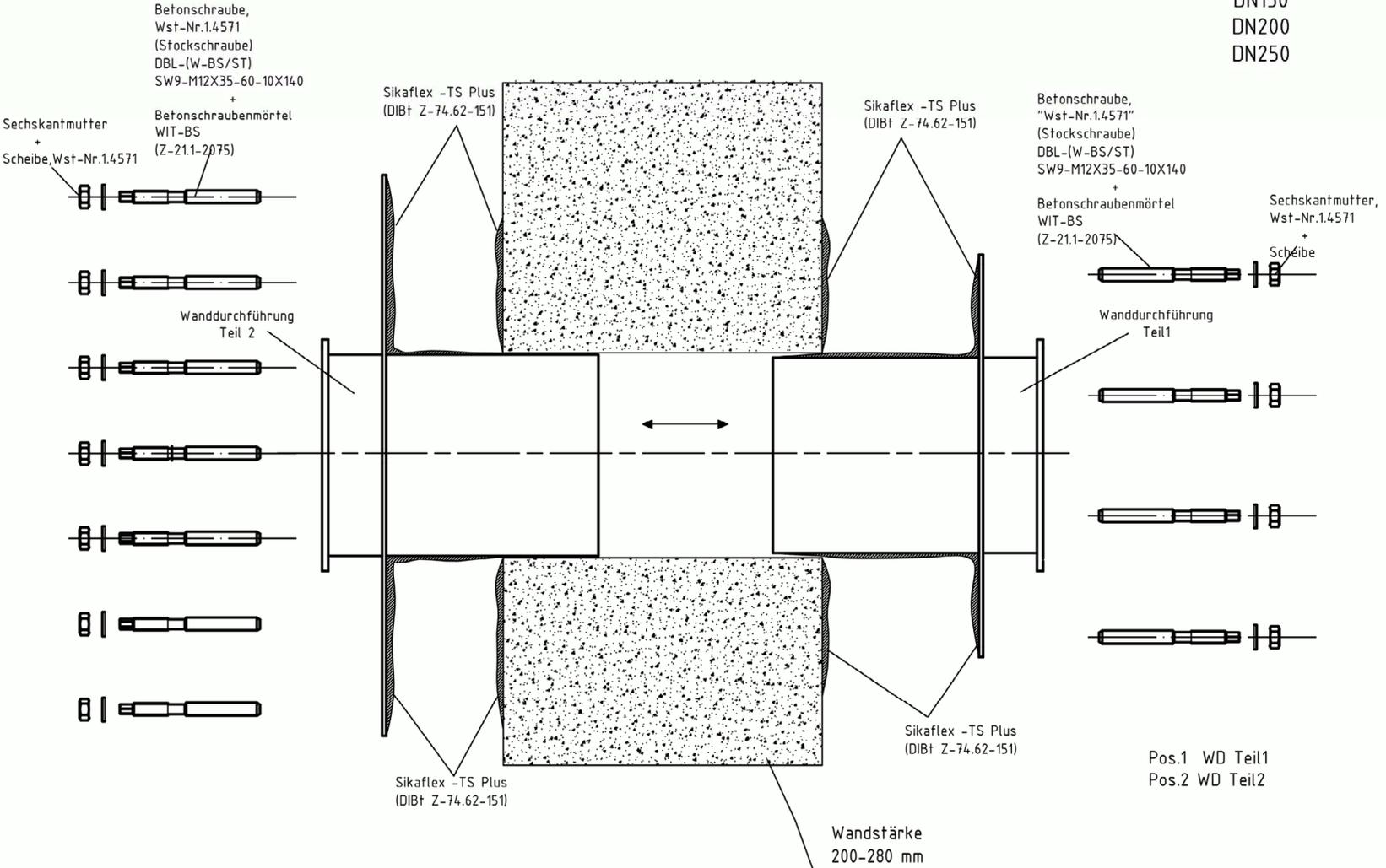
BHM Wanddurchführung für Lagerbehälter von JGS-Anlagen und Biogas-LA-Anlagen
