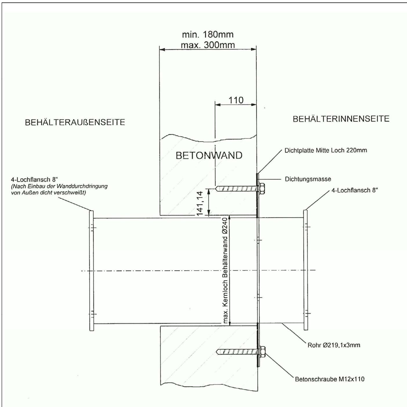
Lantec Wanddurchdringung für Lagerbehälter von JGS-Anlagen und Biogas-LA-Anlagen
