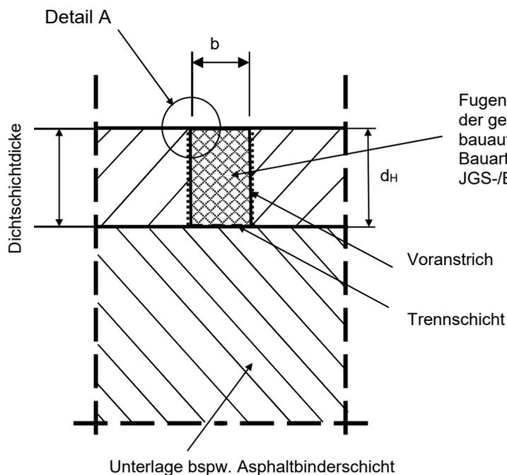
Fugendichtstoff bzw. Fugendichtmasse, der geeignet ist und über eine allgemeine bauaufsichtliche Zulassung/allgemeine Bauartgenehmigung für die Verwendung in JGS-/Biogasanlagen verfügt.
