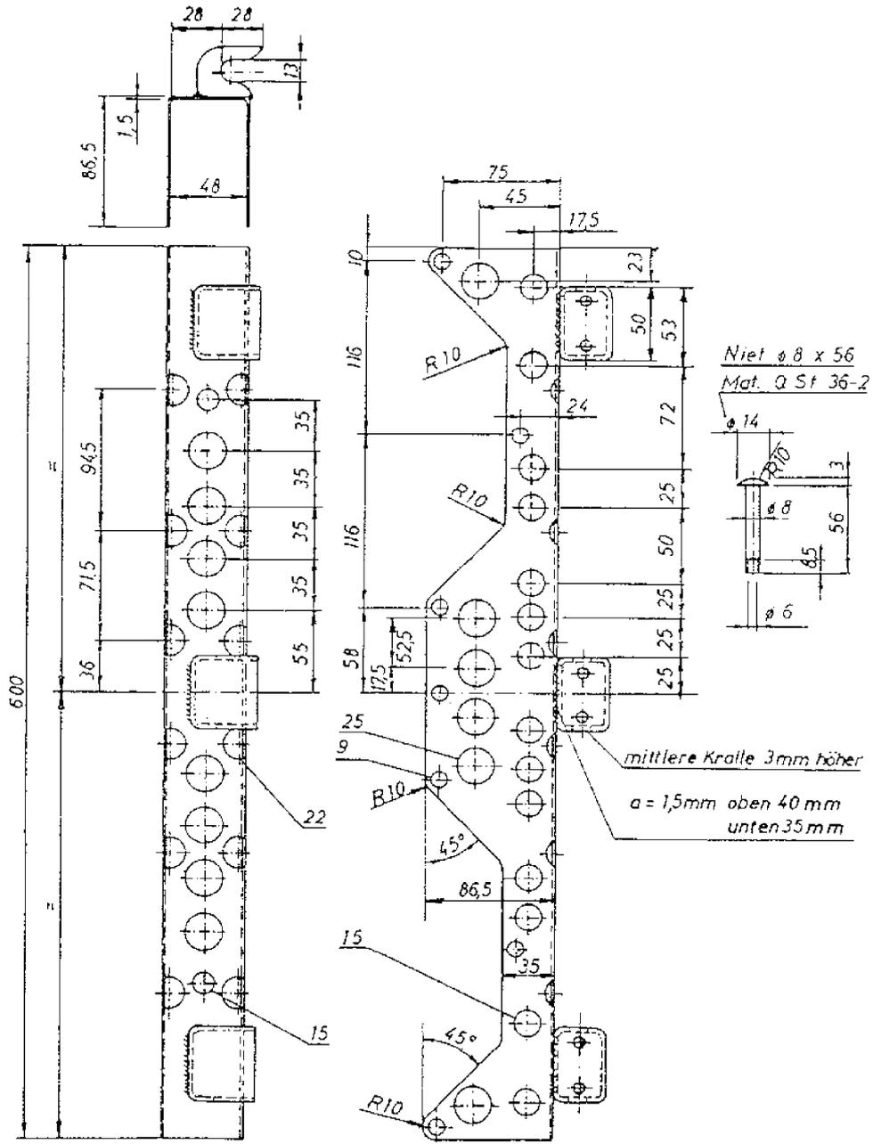
Kappe STW 22 } nach DIN1614 T.1 -  $\beta_z \geq 360 \text{ N/mm}^2$
