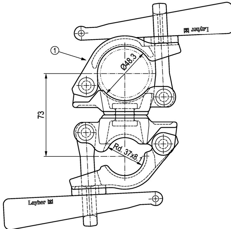
① Drehkupplung mit Keilverschluss Klasse A, EN 74-1
