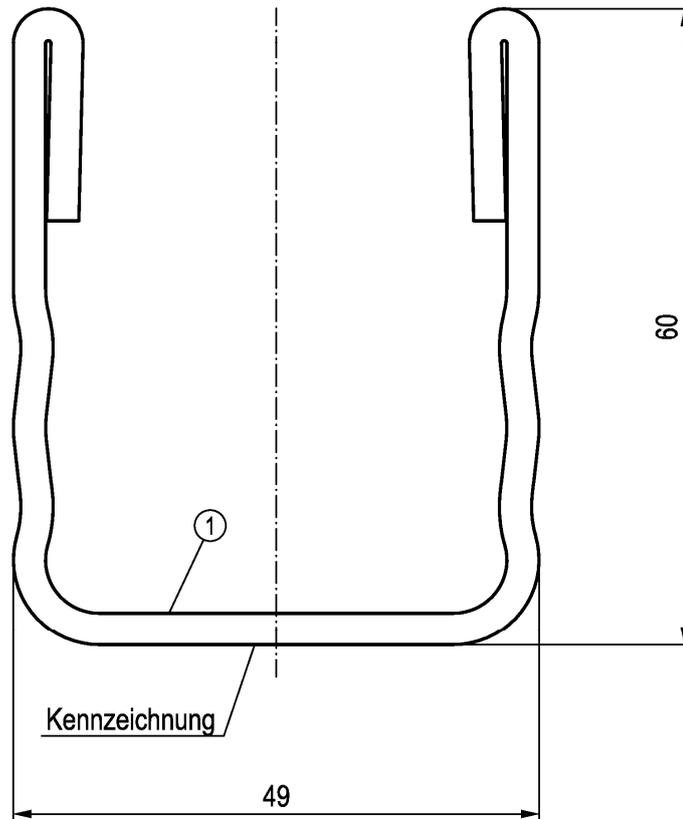
① U-Profil 49 x 60 x 3 EN 10025-2 - S235JR  $R_{eH} \geq 320 \text{ N/mm}^2$
