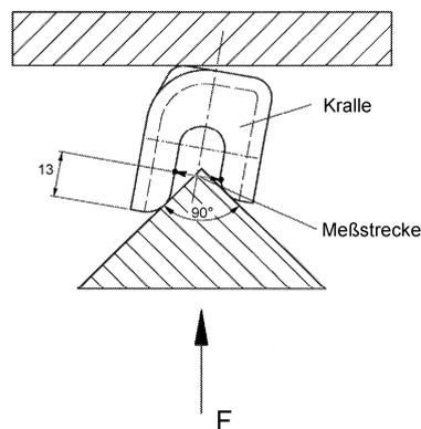
**Bild 1:** Aufweitversuch mit Belagkrallen
