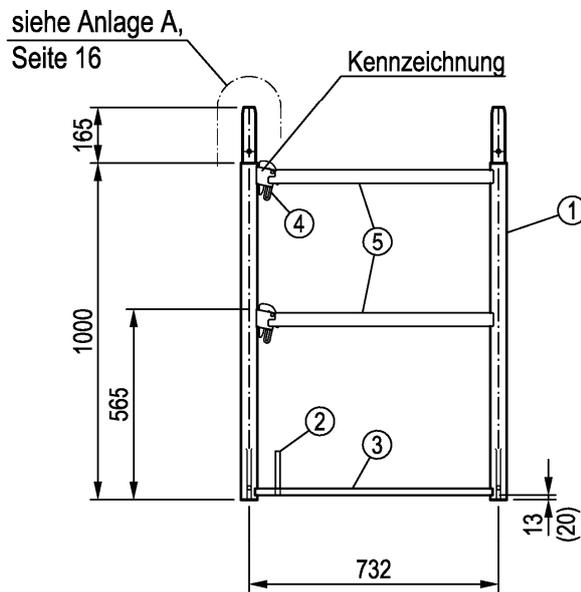
Zur Sicherung der obersten Gerüstböden gegen Abheben, die Geländerstütze mit zwei Fallstecker sichern!
