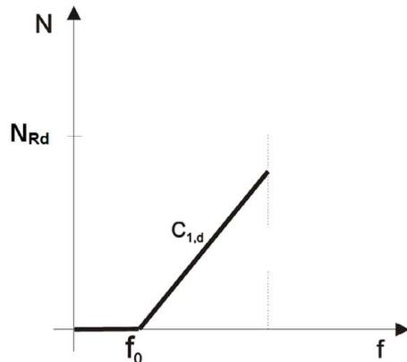
**Bild 7:** bilineare Federkennlinie
