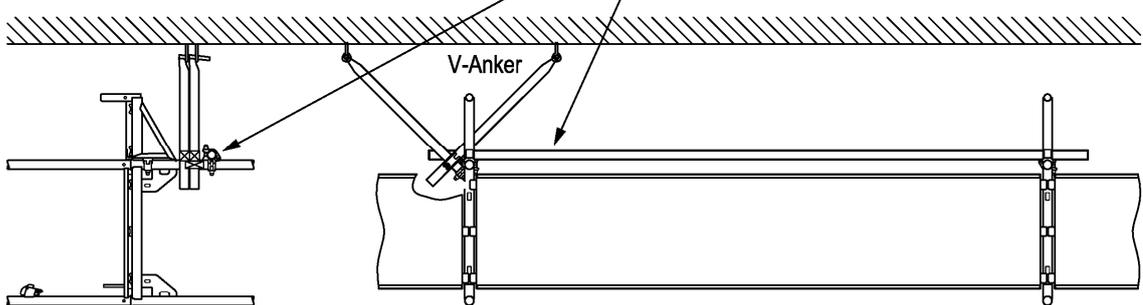
Horizontalrohre auf beiden Seiten des V-Ankers
