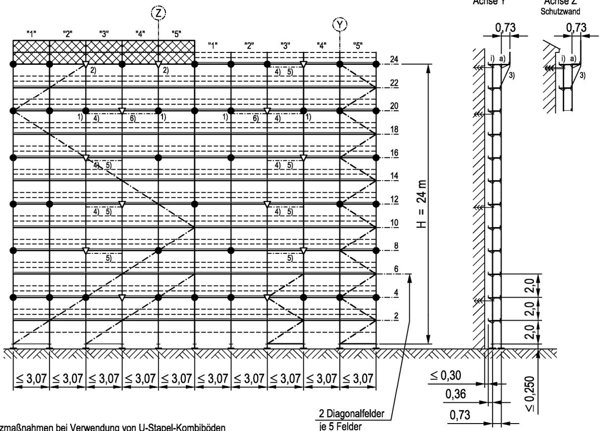
Zusatzmaßnahmen bei Verwendung von U-Stapel-Kombiböden nach Anlage A, Seiten 164, 188 und 189:
