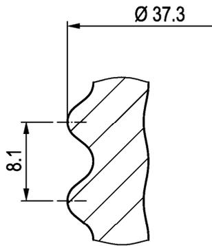
Sondergewinde  $\text{\O} 38 \times 8.1$
