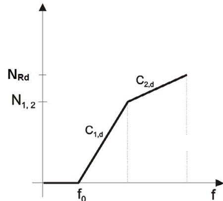
**Bild 8:** trilineare Federkennlinie
