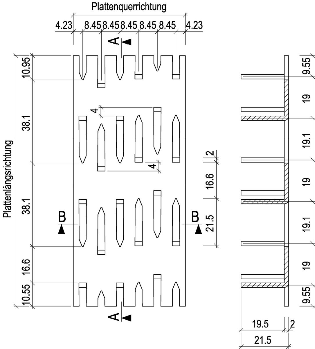
SCHNITT A-A in Längsrichtung
