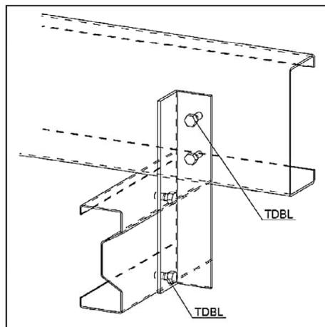
**Verbindungselemente zur Verbindung von Bauteilen aus Stahl**
