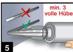
5. Mörtelvorlauf ist nicht zur Befestigung des Bewehrungsseisens geeignet. Daher Vorlauf solange verwerfen, bis sich eine gleichmäßig graue Mischfarbe eingestellt hat, jedoch min. 3 volle Hübe.
