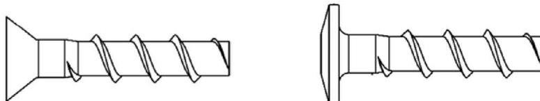
z.B. TOGE Betonschraube TSM L, Ausführung mit Linsenkopf und Anbauteil
