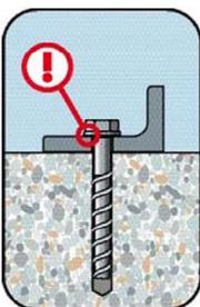
Montage ist erfolgt, wenn der Kopf am Anbauteil anliegt und nicht beschädigt ist.
