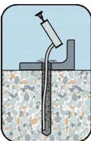
Bohrloch durch ausblasen oder aussaugen vom Grund her reinigen. Bei Verwendung eines Saugbohrers kann eine zusätzliche Bohrlochreinigung entfallen.
