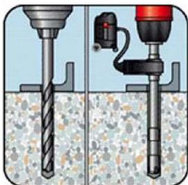
Bohrloch mit Hammer- oder Saugbohrer herstellen
