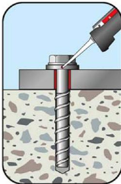
Durch die Bohrung in der Verfüllscheibe mit Hilfe der Mischerreduzierung den Ringspalt zwischen Bolzenanker und Anbauteil verfüllen bis Mörtel aus dem Loch der Verfüllscheibe austritt. Es können Würth Injektionsmörtel mit einer Druckfestigkeit  $\geq 40 \text{ N/mm}^2$  verwendet werden wie z.B. BETON MULTI WIT-UH 300, ALLROUNDER WIT-VM 250, WIT-PE 1000 oder WIT-BS verwendet werden.
