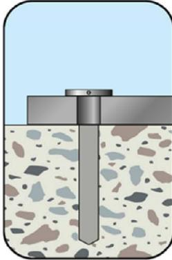
Nach der Bohrlocherstellung (Anhang B5) zuerst das Anbauteil positionieren, dann die Verfüllscheibe über dem Durchgangsloch positionieren.
