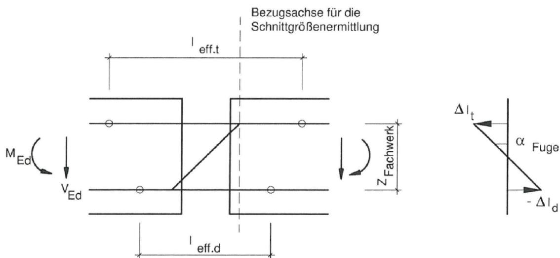
Abb. 49: Modell für die Ermittlung der Biegeverformung in der Fuge
