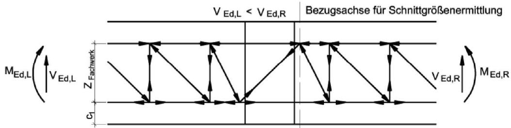
Abb. 40: Schöck Isokorb® Typ D (Typ A und Typ F analog)\*
