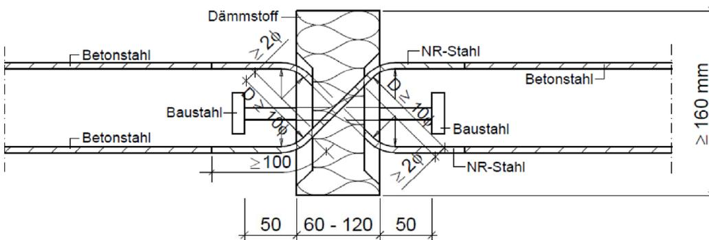
Abb. 22: Schöck Isokorb® Typ Q-VV mit SCE
