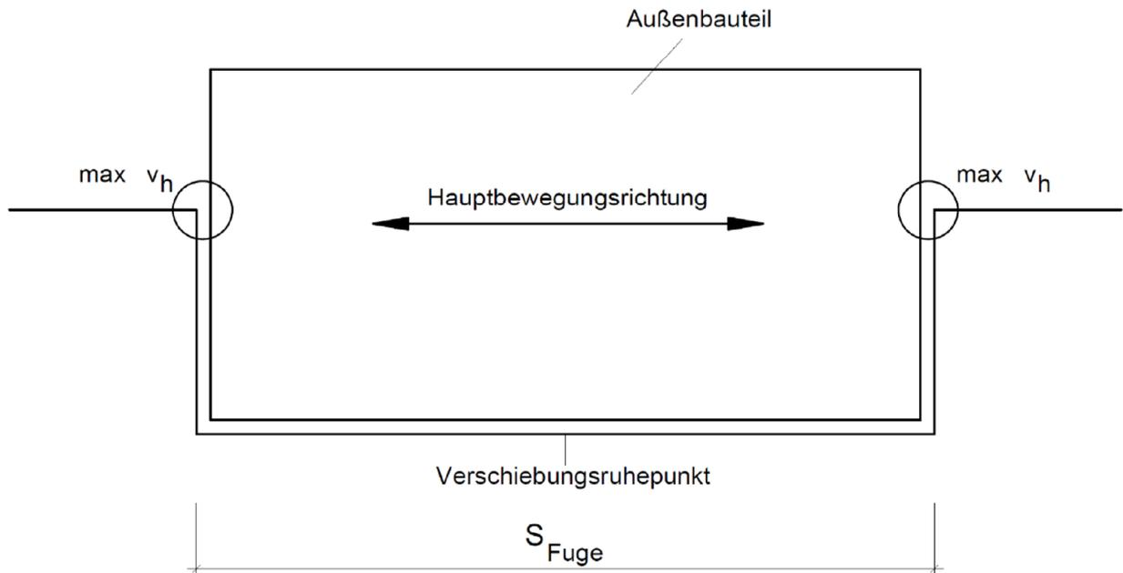
Abb. 13: Einbausituation mit Lagerung zwischen gegenüberliegenden Rändern
