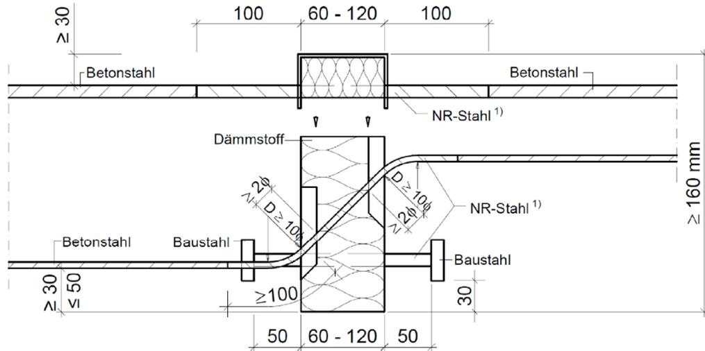
Abb. 16: Schöck Isokorb® Typ K-F (Variante mehrteilig) mit SCE
