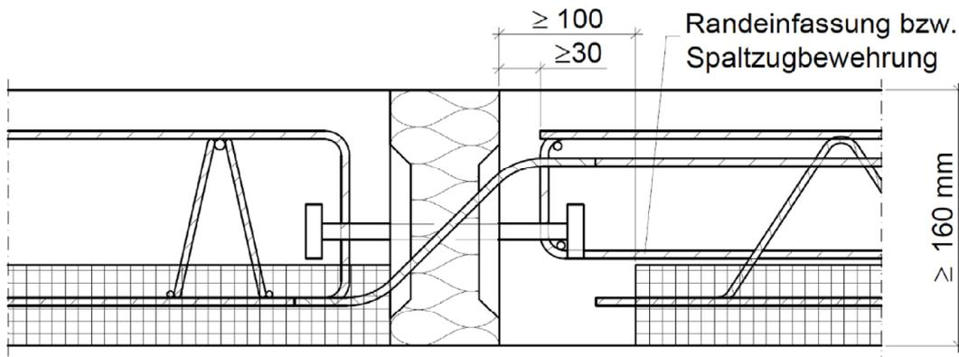
Abb. 30: Beispiel Schöck Isokorb® Typ Q mit Elementplatten
