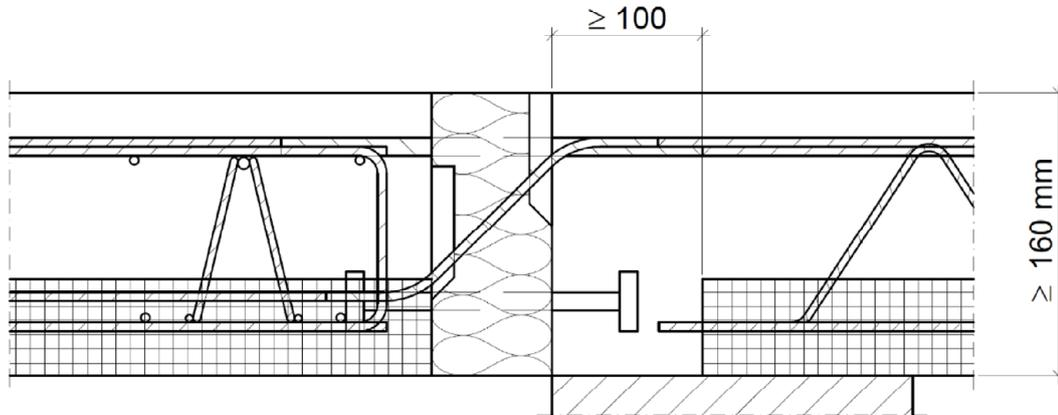
Abb. 29: Beispiel Schöck Isokorb® Typ K und Typ K-F (Variante mehrteilig) mit Elementplatten
