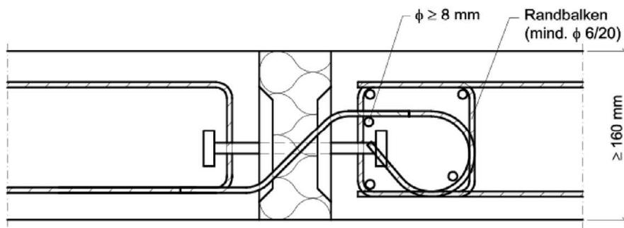
Abb. 48: Beispiel Schöck Isokorb® Typ Q mit SCE und Ausführung als Randbalken
