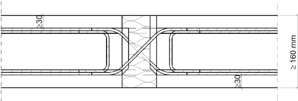
Abb. 24: Beispiel Schöck Isokorb® Typ D mit SCE und bauseitiger Bewehrung
