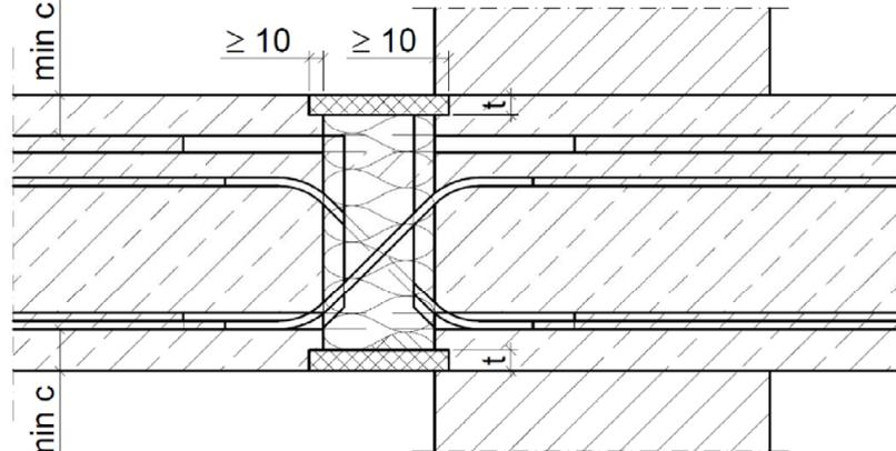
Abb. 33: Schöck Isokorb® Typ D (analog Typ A und Typ F) mit SCE
