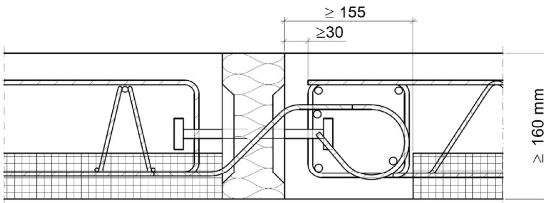
Abb. 31: Beispiel Schöck Isokorb® Typ Q mit Elementplatten
