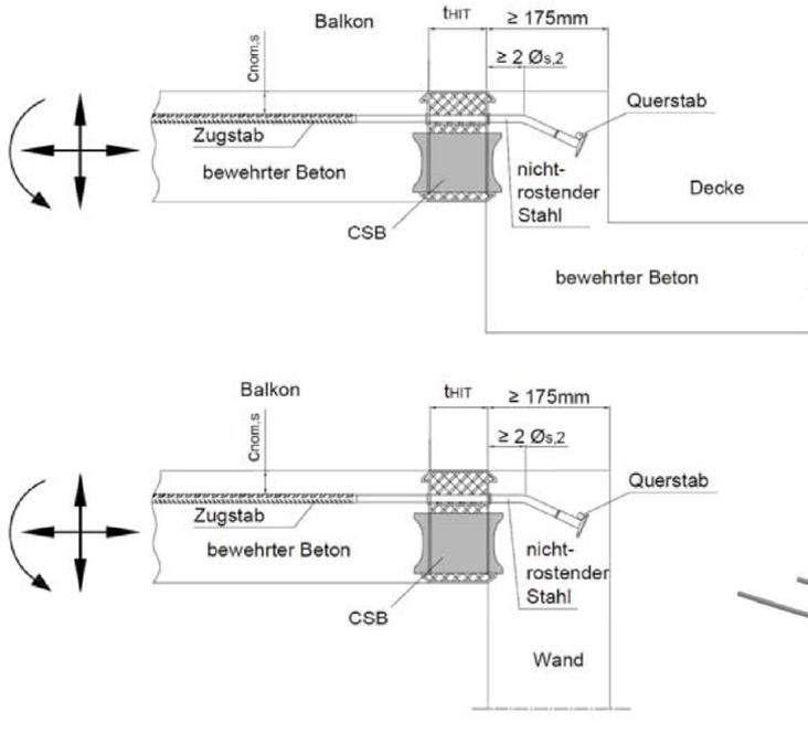
Bild 3: Halfen Iso-Element HIT- HP/SP MVX-...-OU
