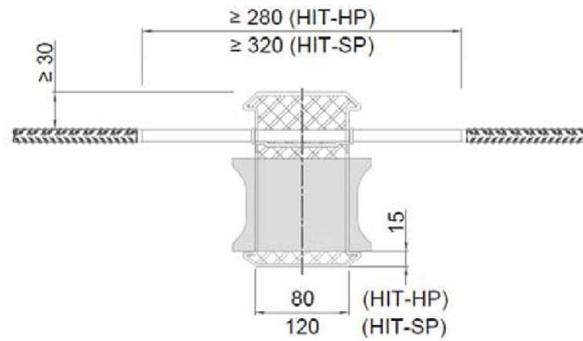
Bild 13: Halben Iso-Element HIT-HP/SP Ausführungsvariante einteilig
