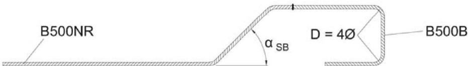
d) Ausführung nichtrostender Betonstahl B500 NR, oberer Querkraftstabschenkel als Schlaufe
