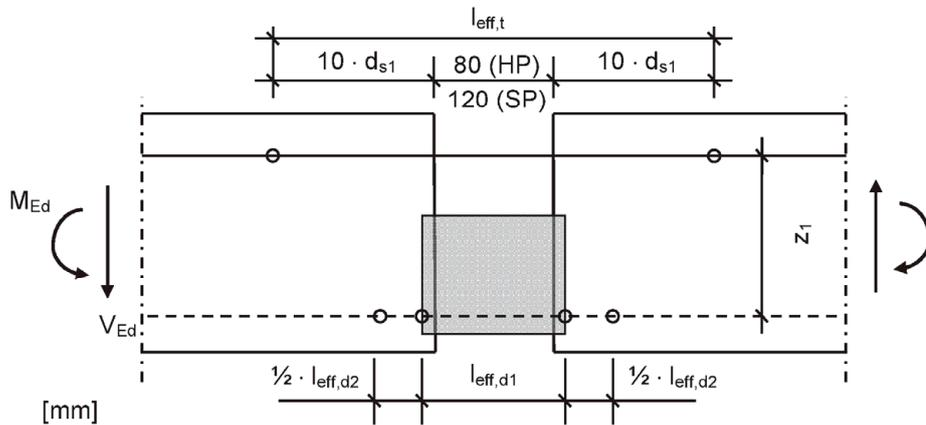
Bild 43:  $l_{\text{eff}}$  für Betonstahl B500 NR
