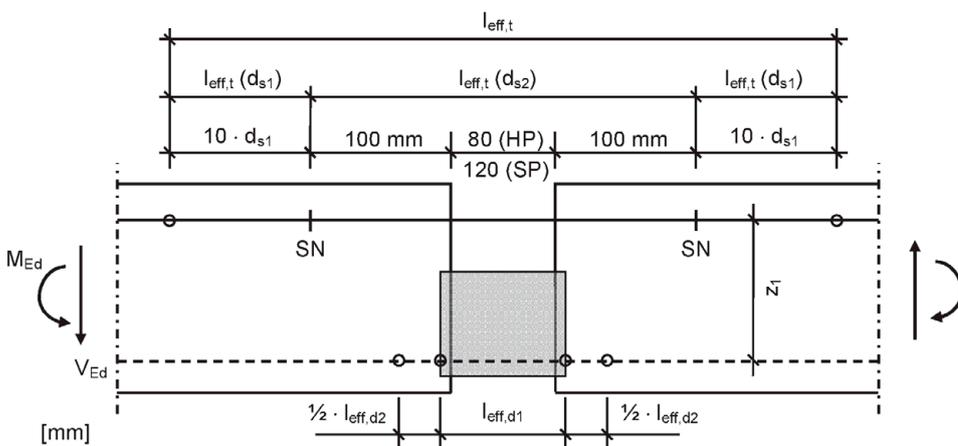
Bild 44:  $l_{\text{eff}}$  für nichtrostenden Rundstahl S 460 und S 690 nach Anhang A15
