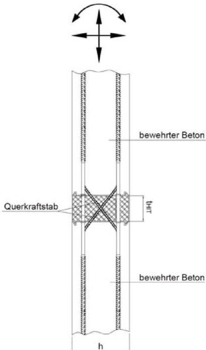
Bild 8: Halfen Iso-Element HIT-HP/SP DD
