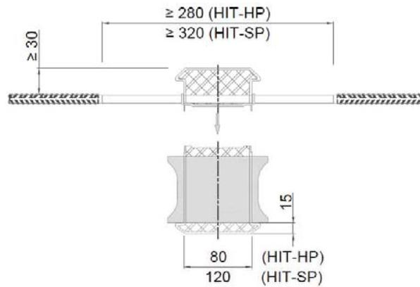
Bild 14: Halben Iso-Element HIT-HP/SP Ausführungsvariante zweiteilig
