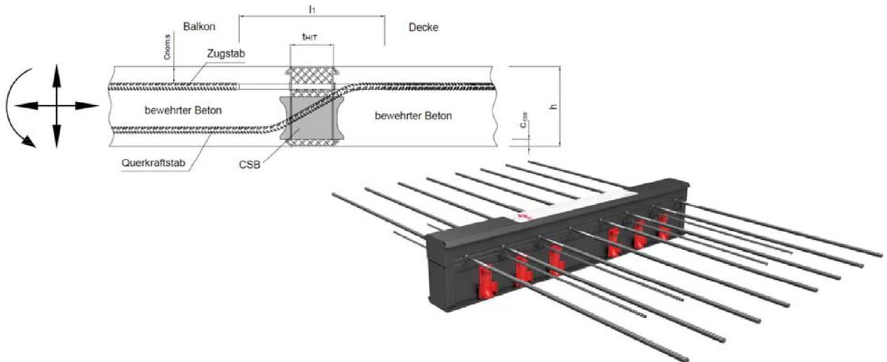
Bild 4: Halfen Iso-Element HIT-HP/SP MVXL
