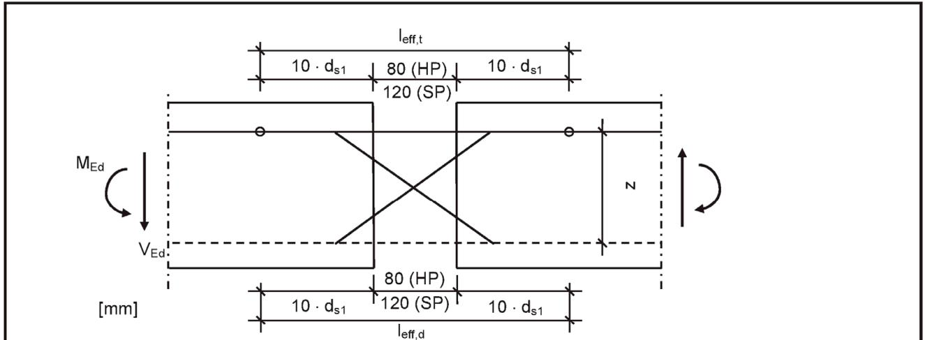
Bild 46:  $l_{eff}$  für Betonstahl,  $d_{s1} = d_{s2}$
