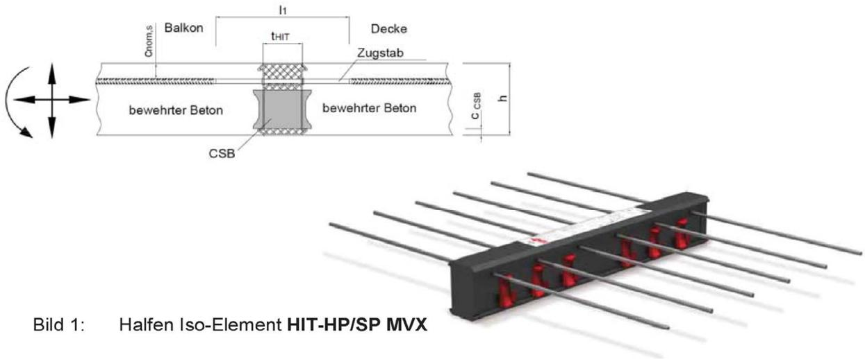
Bild 1: Halben Iso-Element HIT-HP/SP MVX
