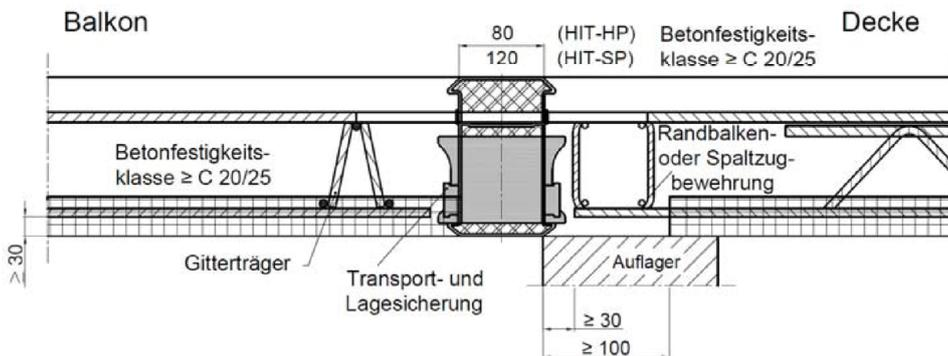
Bild 23: Beispiel für den Anschluss HIT-HP/SP MVX an Elementplatten mit statisch wirksamer Ortbetonschicht
