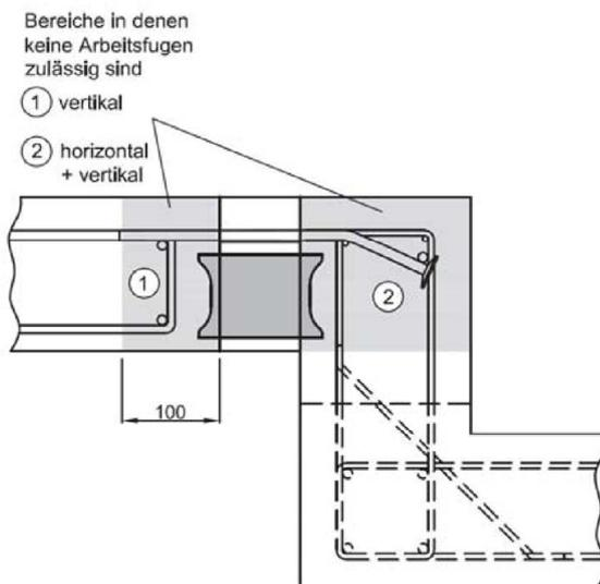
Bild 30: Bewehrungsführung für Höhenversatz HIT-HP/SP MVX\_OU
