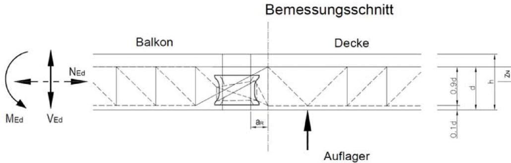
Bild 39: Fachwerkmodell und Bemessungsschnitt **HIT-HP/SP MVXL** mit Druckschublager
