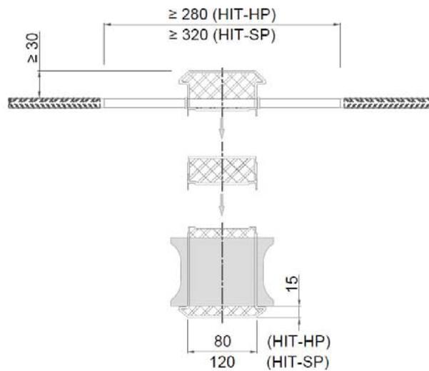
Bild 15: Halben Iso-Element HIT-HP/SP Ausführungsvariante mehrteilig
