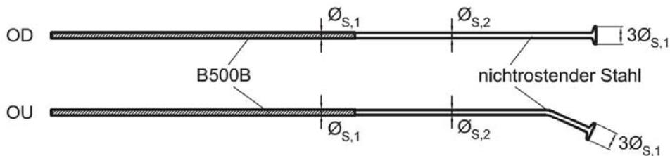
Bild 17: Zugstabvarianten Halfen Iso-Element HIT-HP/SP MVX-OU/OD
