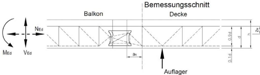
Bild 34: Fachwerkmodell und Bemessungsschnitt **HIT-HP/SP MVX** mit Druckschublager
