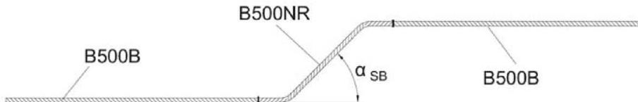
b) Ausführung nichtrostender Betonstahl B500 NR in Kombination mit B500B
