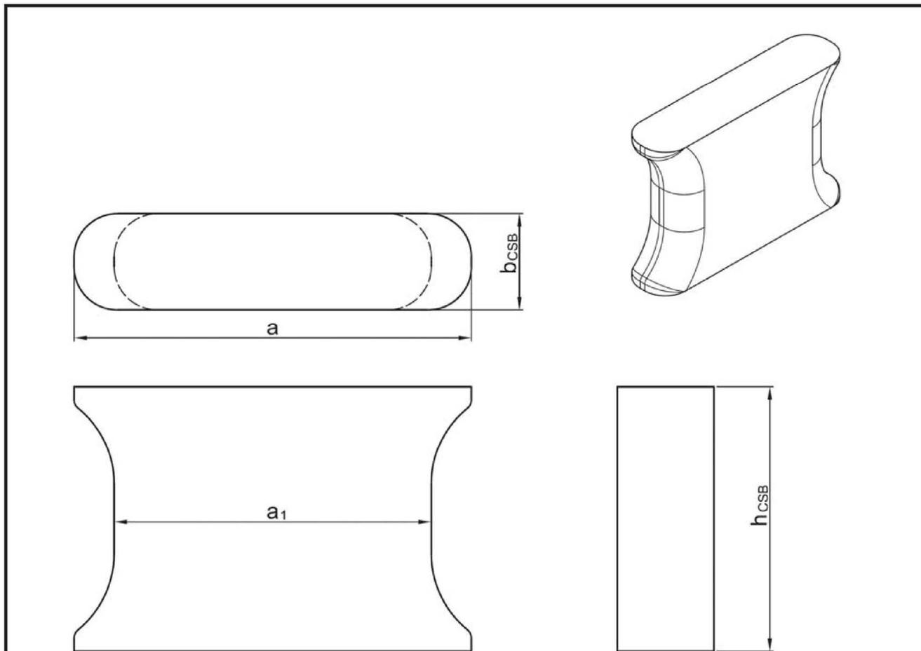
Bild 19: Doppelsymmetrische Druckschublager (CSB)
