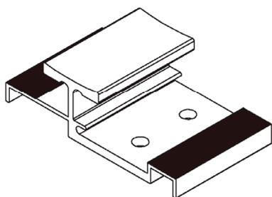
Alle Maße in mm Material Aluminium EN6060 T66 Toleranzen nach EN 755-9
