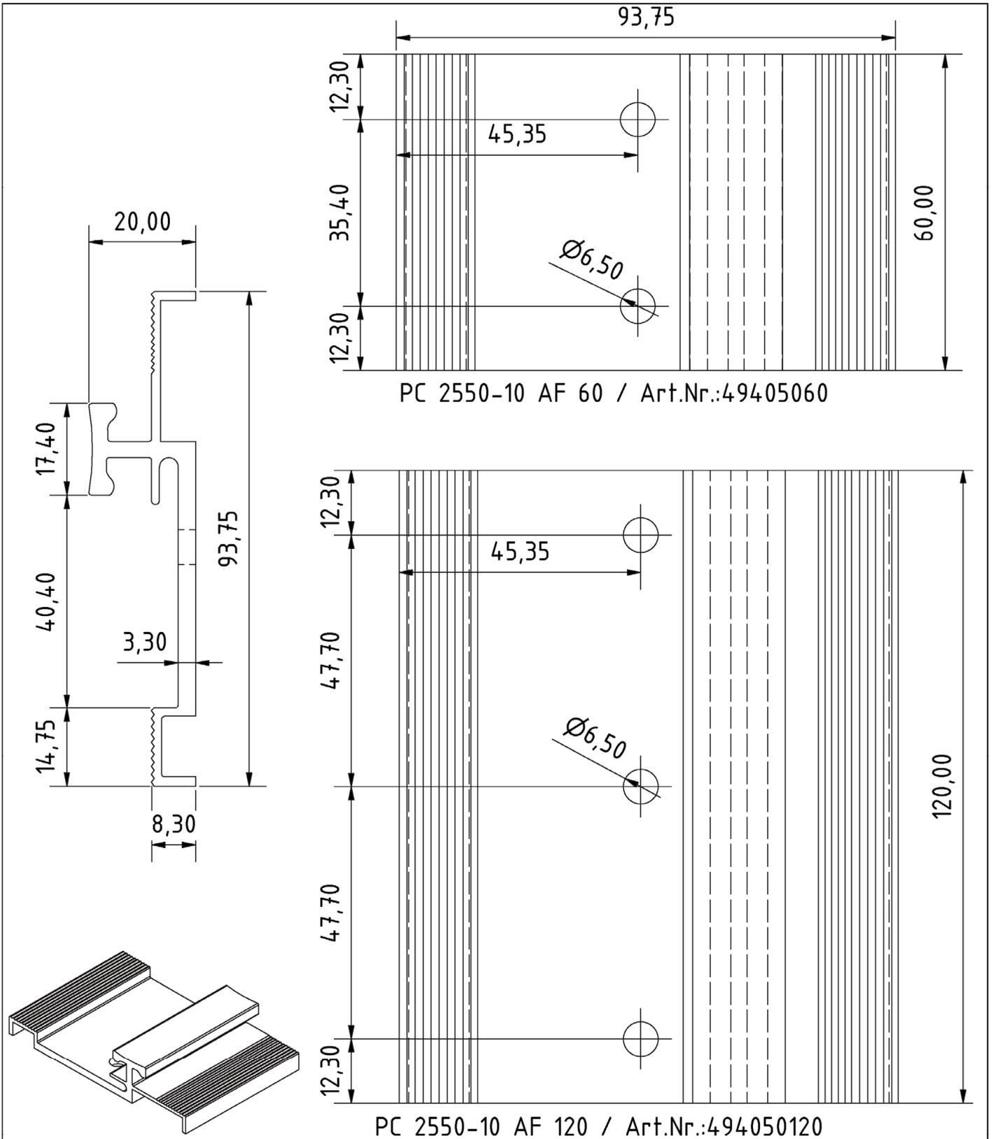
Alle Maße in mm Material Aluminium EN6060 T66 Toleranzen nach EN 755-9
