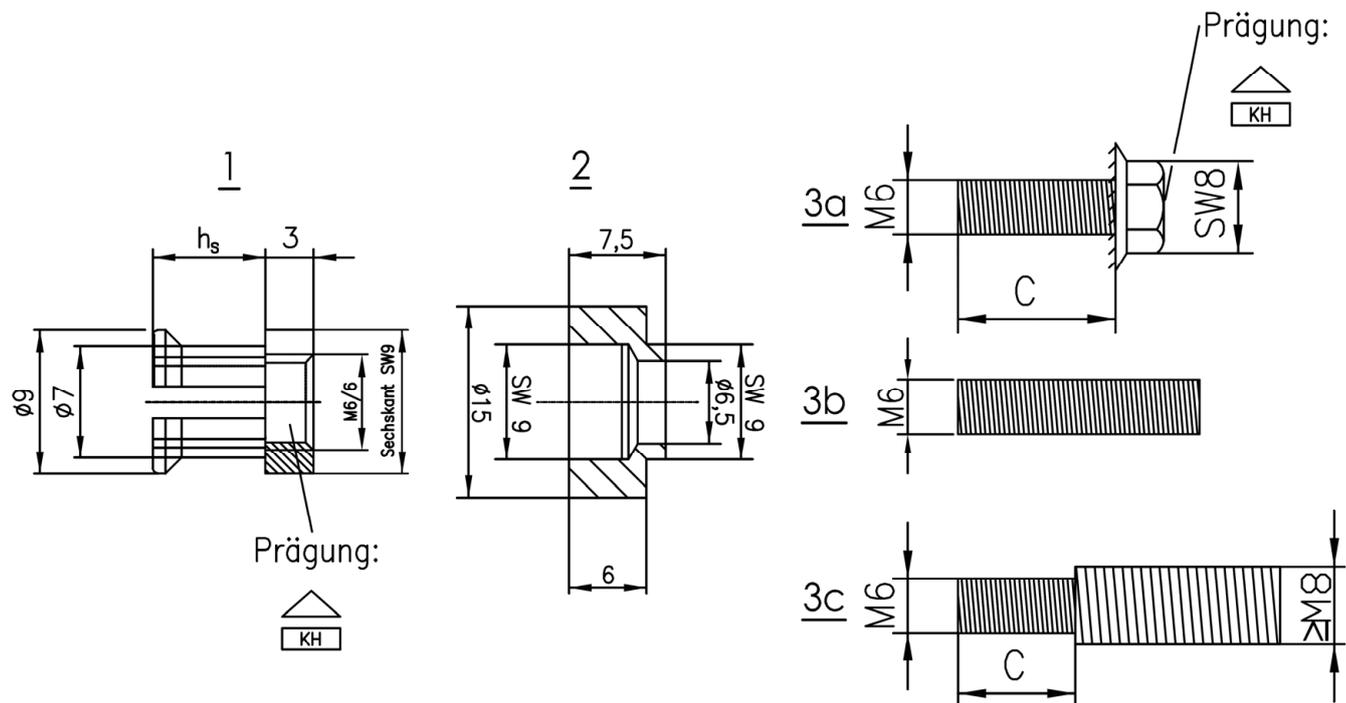
c: die Schraubenlänge ist auf die jeweilige Unterkonstruktion und Setztiefe des Ankers abzustimmen
