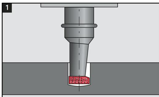
b) hinterschneiden und reinigen
