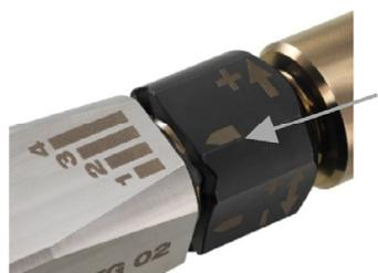
Die Bolzenführung des Gerätes ermöglicht die Einstellung der Eintreibtiefe. Der Vorderteil ist drehbar und in die Positionen 1, 2, 3 und 4 einstellbar.
