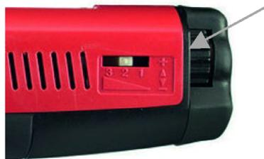
Rad am Setzgerät ermöglicht kontinuierliche Regelung der Eintreibenergie:
