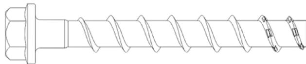
z.B. UIP Betonschraube zinklamellenbeschichtet, Ausführung mit Sechskantkopf und Anbauteil
