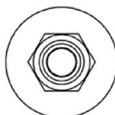
11. Ausführung mit Innengewinde und Sechskantantrieb z.B. CSG-III-MI 6x55 IM M8/10
