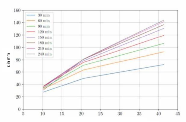
Mindestschichtdicke des Brandschutzputzes in mm
