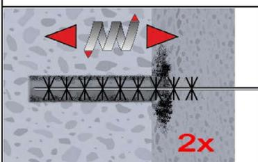
**2e.** Bürstendurchmesser prüfen (Tabelle B4). Das Bohrloch ist mit geeigneter Drahtbürste  $> d_{b,min}$  (Tabelle B4) minimum 2x mit Drehbewegungen auszubürsten.
