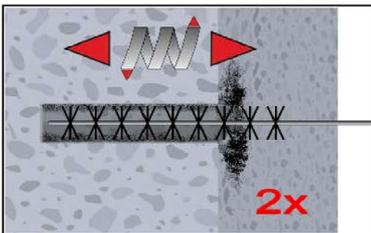
**2b.** Bürstendurchmesser prüfen (Tabelle B4). Das Bohrloch ist mit geeigneter Drahtbürste  $> d_{b,min}$  (Tabelle B4) minimum 2x mit Drehbewegungen auszubürsten.
