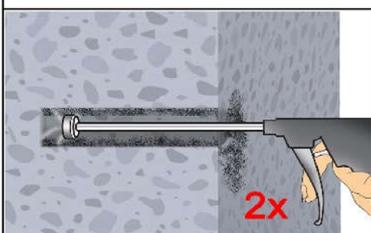
**2d.** Das Bohrloch vom Bohrlochgrund her 2x vollständig mit Druckluft (min. 6 bar) (Anhang B 4) ausblasen, bis die ausströmende Luft staubfrei ist. Bei tiefen Bohrlöchern sind Verlängerungen zu verwenden.
