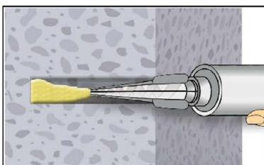
6. Gereinigtes Bohrloch vom Bohrlochgrund her ca. zu 2/3 mit Verbundmörtel befüllen. Langsames Zurückziehen des Statikmischers aus dem Bohrloch verhindert die Bildung von Luftporen. Wird der Bohrlochgrund nicht erreicht, muss eine passende Mischerverlängerung verwendet werden. Die temperaturrelevanten Verarbeitungszeiten (Tabelle B5) sind zu beachten.
