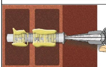
7. Die Siebhülse vom Grund her mit Mörtel füllen. Die exakte Mörtelmenge ist dem Kartuschenetikett oder der Montageanleitung zu entnehmen. Die temperaturrelevanten Verarbeitungszeiten (Tabelle B4 + B5) sind zu beachten. Bei einer Durchsteckmontage muss die Siebhülse bis ins Anbauteil komplett mit Mörtel verfüllt sein.
