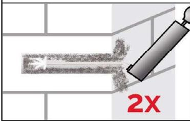
5c. Abschließend erneut das Bohrloch vom Bohrlochgrund her 2x vollständig mit einer Handpumpe (Anhang B4) ausblasen.
