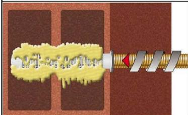
8. Befestigungselement mit leichten Drehbewegungen bis zur festgelegten Setztiefe einführen. Die Ankerstange muss frei von Schmutz-, Fett, Öl und anderen Fremdmaterialien sein.
