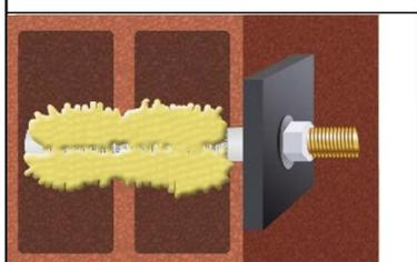
10. Nach vollständiger Aushärtung kann das Anbauteil mit bis zu dem maximalen Drehmoment (Anhänge C4 - C40) montiert werden. Die Mutter muss mit einem kalibriertem Drehmomentschlüssel festgezogen werden.
