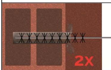
5b. Eine geeignete Drahtbürste  $> d_{b,min}$  (Tabelle B3) an einer Bohrmaschine oder einen Akkuschauber einstecken und das Bohrloch minimum 2x auszubürsten. Wird der Bohrlochgrund mit der Bürste nicht erreicht, muss eine Bürstenverlängerung verwendet werden.
