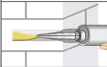
6. Das Bohrloch vom Grund her zu mindestens 2/3 mit Mörtel füllen. Langsames Zurückziehen des Statikmischers aus dem Bohrloch verhindert die Bildung von Lufteinschlüssen. Die temperaturrelevanten Verarbeitungszeiten (Tabelle B4 + B5) sind zu beachten.
