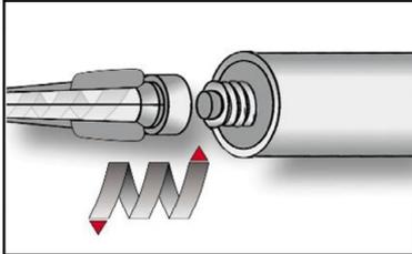
1. Die Kappe von der Kartusche entfernen und den mitgelieferten Statikmischer fest auf die Kartusche aufschrauben und Kartusche in eine geeignete Auspresspistole einlegen. Bei Schlauchfolien den Clip vor der Verwendung abschneiden. Bei jeder Arbeitsunterbrechung länger als die empfohlene Verarbeitungszeit (Tabelle B4 und B5) und bei jeder neuen Kartusche ist der Statikmischer zu erneuern.
