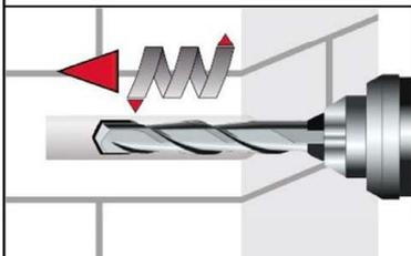
4. Das Bohrloch, senkrecht zur Oberfläche des Verankerungsgrundes, unter Verwendung eines Hartmetallbohrers mit Bohrverfahren nach Anhang C4-C40, mit vorgeschriebenem Bohrernennendurchmesser und Bohrlochtiefe entsprechend der Ankergröße und Einbindetiefe des gewählten Dübels, im Verankerungsgrund erstellen. Bei Fehlbohrungen ist das Bohrloch zu vermörteln.
