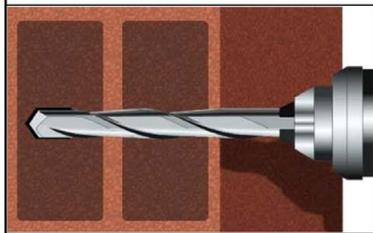
4. Das Bohrloch, senkrecht zur Oberfläche des Verankerungsgrundes, unter Verwendung eines Hartmetallbohrers mit Bohrverfahren nach Anhang C4 - C40, mit vorgeschriebenem Bohrerinnendurchmesser und Bohrlochtiefe entsprechend der Ankergröße und Einbindetiefe des gewählten Dübels, im Verankerungsgrund erstellen. Bei Fehlbohrungen ist das Bohrloch zu vermörteln.
