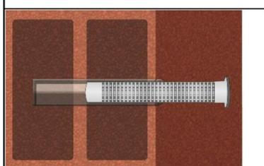
6. Die Siebhülse bündig mit der Oberfläche des Verankerungsgrundes in das Bohrloch einstecken. Sicherstellen, dass die Siebhülse optimal ins Bohrloch passt. Siebhülse niemals kürzen. Für die Installation durch Wärmedämmung hindurch oder für eine Durchsteckmontage und unter Verwendung der Siebhülse BS16x130/330 wird diese am Kopfende entsprechend der Dicke der Wärmedämmschicht gekürzt.
