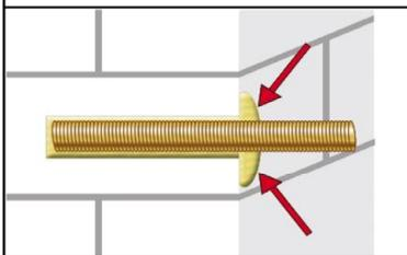
8. Nach der Installation des Ankers muss der Ringspalt zwischen Ankerstange und Mauerstein, bei Durchsteckmontage zusätzlich auch im Anbauteil, komplett mit Mörtel ausgefüllt sein. Tritt keine Masse nach Erreichen der Verankerungstiefe heraus, ist diese Voraussetzung nicht erfüllt und die Anwendung muss vor Beendigung der Verarbeitungszeit wiederholt werden.
