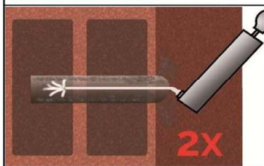
5a. Das Bohrloch vom Bohrlochgrund her 2x vollständig mit einer Handpumpe (Anhang B4) ausblasen.
