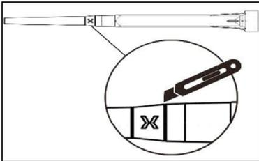
3a. Bei Verwendung der Mischerverlängerung VL16/1,8, muss die Spitze des Mixers an der Position „X“ abgeschnitten werden.
