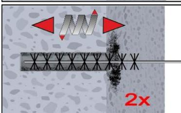
2e. Bürstendurchmesser prüfen (Tabelle B5). Das Bohrloch ist mit geeigneter Drahtbürste  $> d_{b,min}$  (Tabelle B5) minimum 2x mit Drehbewegungen auszubürsten.
