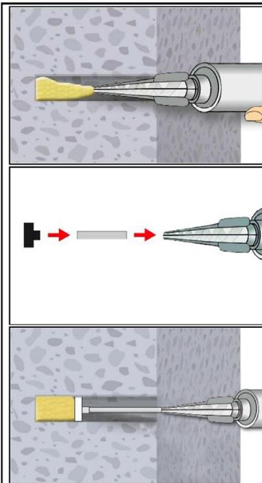
6a. Das gereinigte Bohrloch vom Bohrlochgrund her ca. zu 2/3 mit Verbundmörtel befüllen. Langsames Zurückziehen des Statikmischers aus dem Bohrloch verhindert die Bildung von Luftporen. Wird der Bohrlochgrund nicht erreicht, muss eine passende Mischerverlängerung verwendet werden. Die temperaturrelevanten Verarbeitungszeiten (Tabelle B3) sind zu beachten.
