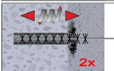
2b. Bürstendurchmesser prüfen (Tabelle B5). Das Bohrloch ist mit geeigneter Drahtbürste  $> d_{b,\text{min}}$  (Tabelle B5) minimum 2x mit Drehbewegungen auszubürsten. Wird der Bohrlochgrund mit der Bürste nicht erreicht, muss eine Bürstenverlängerung verwendet werden.
