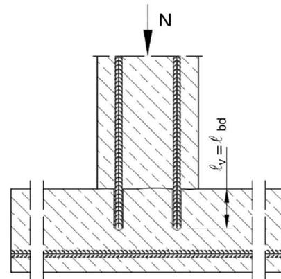
**Bild A5:** Verankerung von Bewehrung zur Deckung der Zugkraftlinien
