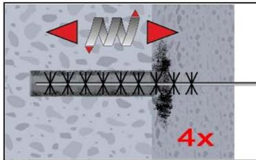
2b. Bürstendurchmesser prüfen (Tabelle B5). Das Bohrloch ist mit geeigneter Drahtbürste  $> d_{b,\text{min}}$  (Tabelle B5) minimum 4x mit Drehbewegungen auszubürsten. Wird der Bohrlochgrund mit der Bürste nicht erreicht, muss eine Bürstenverlängerung verwendet werden.
