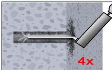
2c. Anschließend das Bohrloch erneut vom Bohrlochgrund her 4x vollständig mit einer Handpumpe (Anhang B 4) ausblasen.
