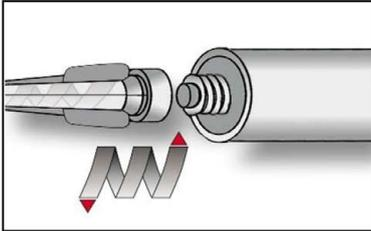
3. Den mitgelieferten Statikmischer fest auf die Kartusche aufschrauben und Kartusche in eine geeignete Auspresspistole einlegen. Bei jeder Arbeitsunterbrechung länger als die maximale Verarbeitungszeit (Tabelle B3) und bei jeder neuen Kartusche ist der Statikmischer zu erneuern.
