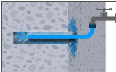
2c. Erneut mit Wasser ausspülen, bis klares Wasser aus dem Bohrloch austritt.
