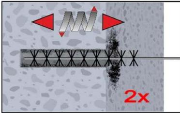
2b. Bürstendurchmesser prüfen (Tabelle B5). Das Bohrloch ist mit geeigneter Drahtbürste  $> d_{b,min}$  (Tabelle B5) minimum 2x mit Drehbewegungen auszubürsten.
