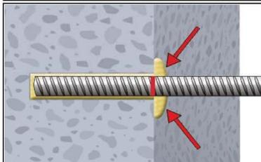
8. Nach Installation des Stabes sicherstellen, dass sich die Setztiefemarkierung am Bohrlochanfang befindet und der Ringspalt komplett mit Mörtel ausgefüllt ist. Tritt keine Masse nach Erreichen der Setztiefe am Bohrlochanfang heraus, ist diese Voraussetzung nicht erfüllt und die Anwendung muss vor Beendigung der Verarbeitungszeit wiederholt werden.
