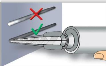
5. Mörtelvorlauf ist nicht zur Befestigung des Bewehrungsstabs geeignet. Daher Vorlauf solange verwerfen, bis sich eine gleichmäßig graue Mischfarbe eingestellt hat, jedoch min. 3 volle Hübe
