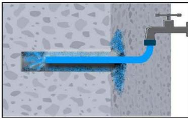
2a. Mit Wasser ausspülen, bis klares Wasser aus dem Bohrloch austritt.
