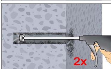
2c. Anschließend das Bohrloch erneut vom Bohrlochgrund her 2x vollständig mit Druckluft (min. 6 bar) (Anhang B 4) ausblasen, bis die ausströmende Luft staubfrei ist. Wird der Bohrlochgrund mit der Bürste nicht erreicht, muss eine entsprechende Verlängerung verwendet werden.
