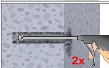
2f. Anschließend das Bohrloch erneut vom Bohrlochgrund her 2x vollständig mit Druckluft (min. 6 bar) (Anhang B 4) ausblasen, bis die ausströmende Luft staubfrei ist. Wird der Bohrlochgrund mit der Bürste nicht erreicht, muss eine entsprechende Verlängerung verwendet werden.
