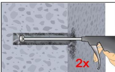
2d. Das Bohrloch vom Bohrlochgrund her 2x vollständig mit Druckluft (min. 6 bar) (Anhang B 4) ausblasen, bis die ausströmende Luft staubfrei ist. Wird der Bohrlochgrund mit der Bürste nicht erreicht, muss eine entsprechende Verlängerung verwendet werden.
