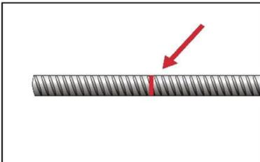
4. Vor dem Injizieren des Mörtels ist die Setztiefe auf dem Bewehrungsstab zu markieren (z.B. mit Klebeband). Danach den Bewehrungsstab in das leere Bohrloch einführen, um die korrekte Bohrlochtiefe  $l_v$  zu überprüfen. Die Ankerstange muss frei von Schmutz-, Fett, Öl und anderen Fremdmaterialien sein.
