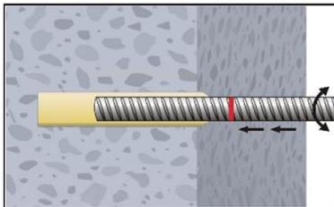
7. Bewehrungsstab mit leichter Drehbewegung (zur Verbesserung der Mörtelverteilung) bis zur Setztiefemarkierung in das Bohrloch einführen.
