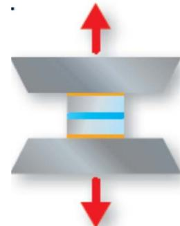
**Verbund-Sicherheitsglas mit der Zwischenschicht
