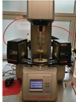
**Abb. A 5.1:** Versuchsaufbau, Rheometer
