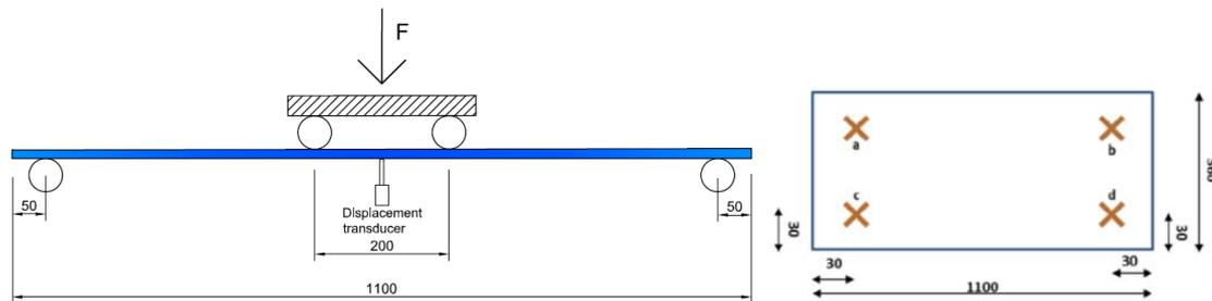
Abb. A 5.2: Biegekriechversuch und Messpunkte
