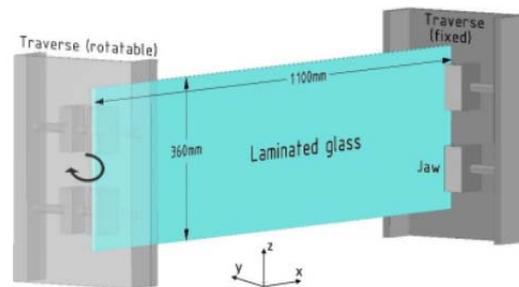
Abb. A 5.3: Torsionsrelaxationsversuch
