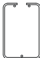
Bild 4: Bügelkorb für: \Delta\sigma_{Rsk} = 175 \text{ MPa} (bei N=1 \cdot 10^6 Lastzyklen)
