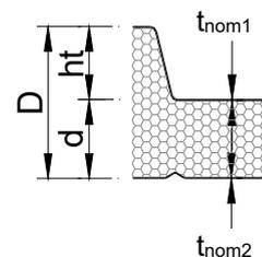
Deckschicht-Kombination und Bezeichnung der Dach- und Wandelemente z. B.
