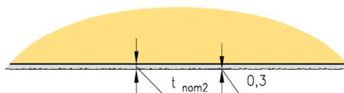
$t_{nom1}$  : Nenndicke der äußeren/oberen Deckschichten
