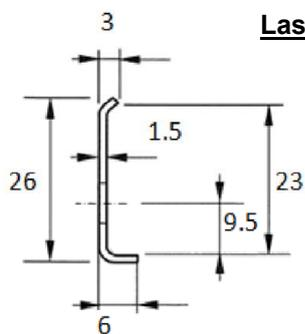
**Lastverteiler:** Nenndicke  $t = 1,5 \text{ mm} \pm 0,10 \text{ mm}$
