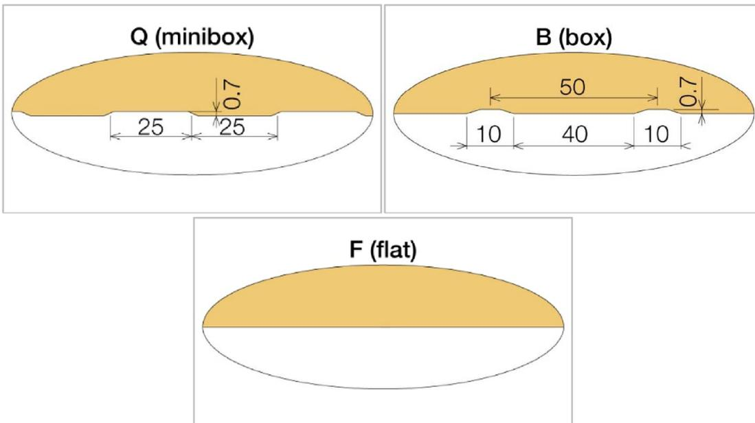
Sandwichelemente "Hoesch isorock HP" nach DIN EN 14509 mit Mineralwolle-Kernschicht zwischen zwei Stahldeckschichten; für Wand- und Dachkonstruktionen
