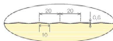
**Profilierungen der inneren Deckschicht**
